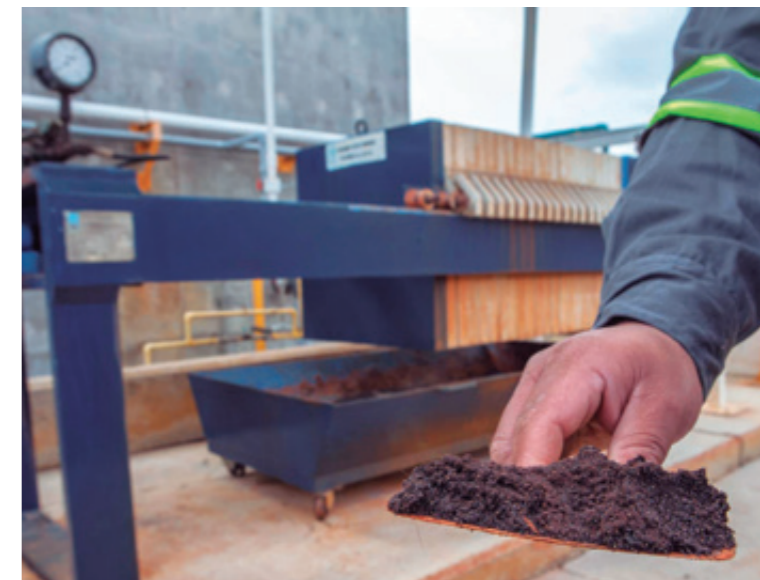
Residuos de una planta potabilizadora en Zimapán.
